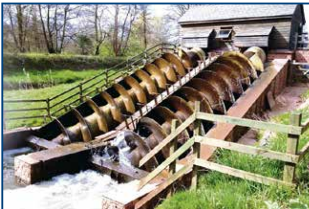
Arhimedova hidrodinamička turbina u pogonu
