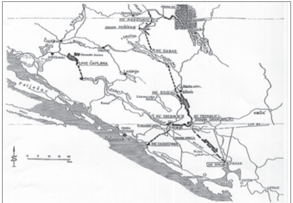
Слика 2. ХЕС „Требишњица“ – пројектована развојна концепција и изграђеност система, са ХЕ Бока - Рисан у склопу ХЕС-а (Енергопројект-Хидроинжењеринг Београд)
