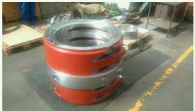
Novi generatorski klizni ležaj
