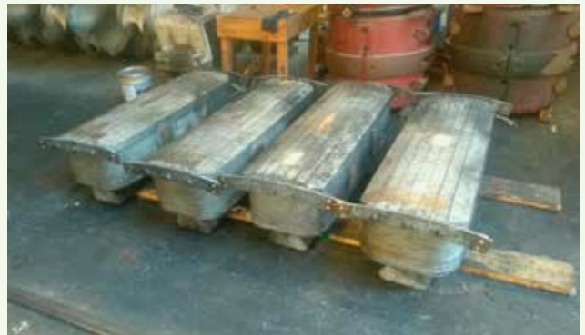
Demontirani polovi generator
