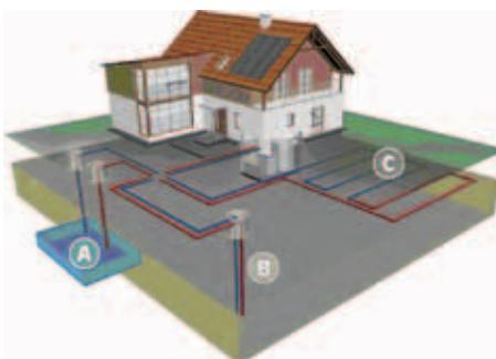
A – podzemne vode; B – geotermalne sonde; C – zemljani kolektori
