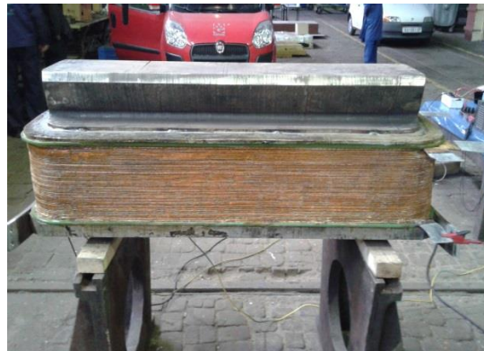
Izolacioni okvir pola generatora G5 na kojem je došlo do proboja izolacije 2015. godine
