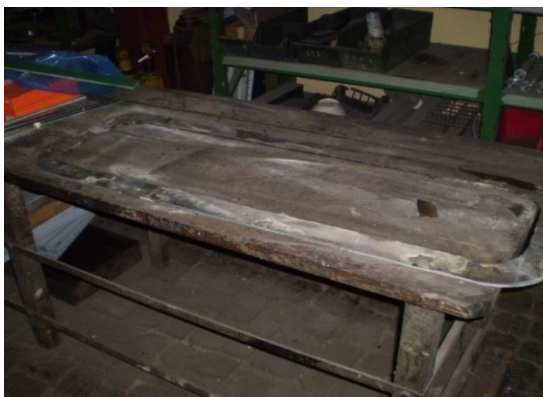
Izolacioni okvir pola generatora G5 na kojem je došlo do proboja izolacije 2015. godine
